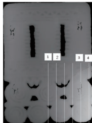
図 7. 変形部分の断面位置
